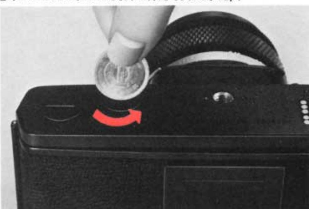
Entfernen des Motorantriebsbuchsendeckels.
