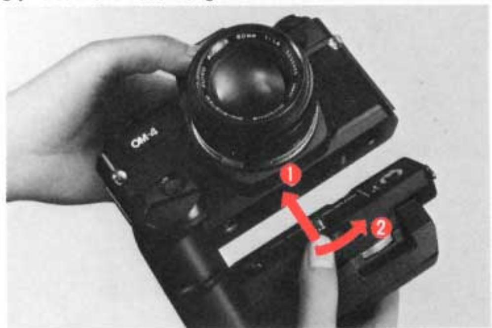
Die Feststellschraube im Uhrzeigersinn drehen.
